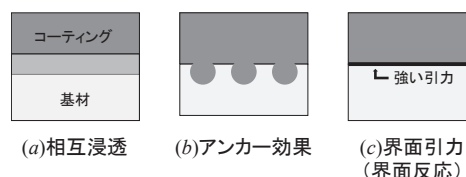
図-1 コーティング膜の基材への密着機構
